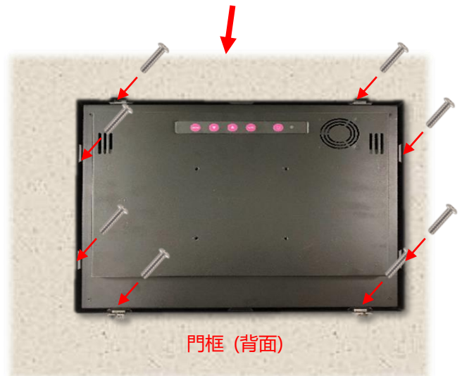
步驟 3: 從背面裝上卡扣後, 以螺絲固定 (視需求或位置限制, 最多可裝 10 個卡扣)
